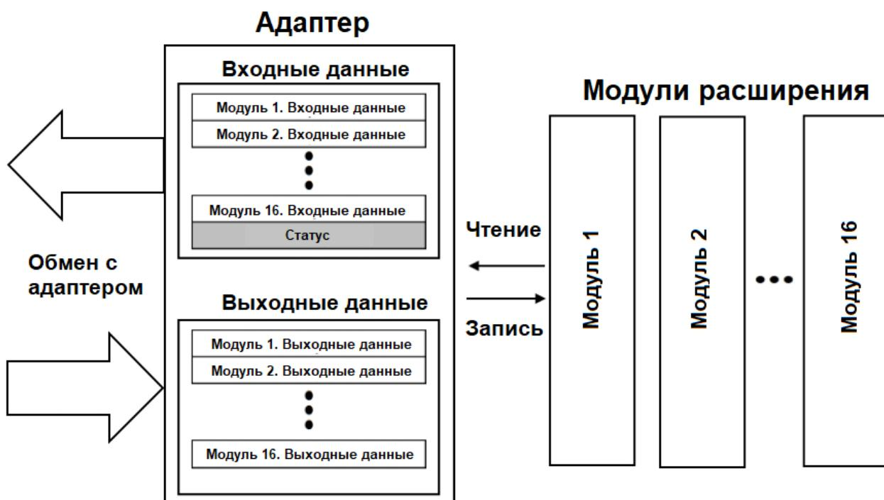
Общая таблица отображения в адаптере автоматически присваивается Modbus регистрам в соответствии со следующими таблицами.
