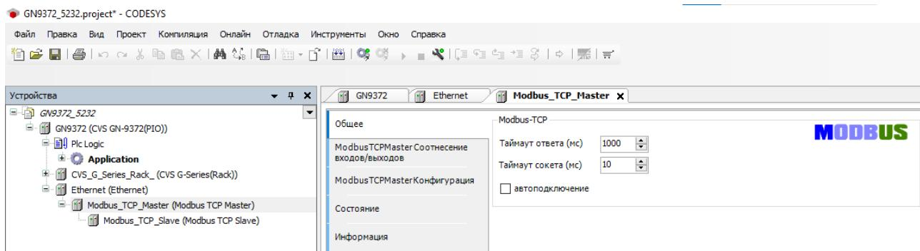
настроить параметры Modbus Slave (IP-адрес, порт, таймаут) и
